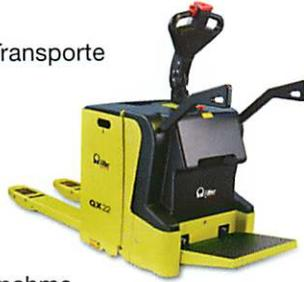
Die Elektro-Hubwagen der QX-Serie sind die richtige Lösung für professionelle Anwendungen im Handling-Bereich. Die SEM\*-Technologie, das elektromagnetische Bremssystem zur Energierückgewinnung und die hohe Geschwindigkeit (8 - 10km/h) in Verbindung mit der Fahrerstandplattform garantieren professionelle Einsätze.
